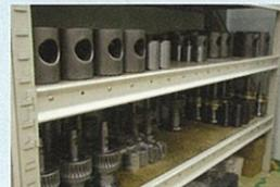
検査室では測定部品を一昼夜置き、常温にして検査
